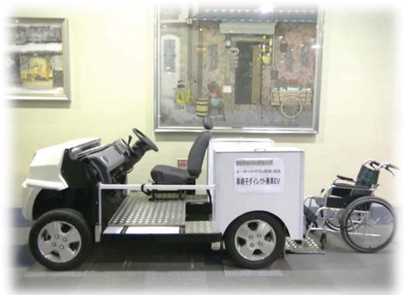
▲ 共同開発した「障害者用バリアフリー車椅子ダイレクト乗車装置」
