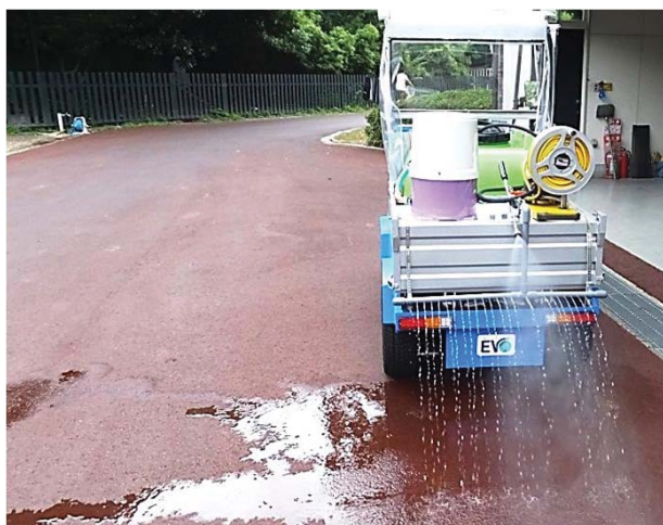
▲ ハウステンボスに試験導入した散水ができるEVトラック
